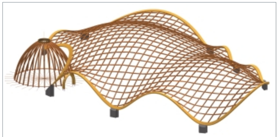
■ Abbildung 2: Animation der Holzrippenschale der Toskana Therme, Bad Orb; Darstellung: Trabert + Partner, Geisa
